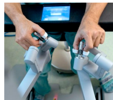
◀ Die Steuerung der Roboterarme funktioniert über eine Konsole und mit Hilfe kleiner Schlaufen, in die der Chirurg seine Finger steckt. Die Bewegungen der Hände werden auf den Roboter übertragen.
